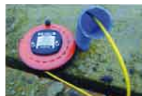
Détection canalisation plastique avec canne de traçage ou sonde
